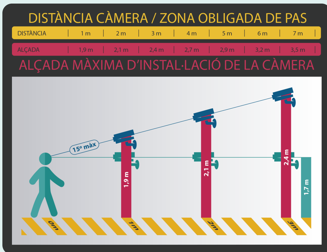
Figura 2. Valors recomanats d'alçada màxima de les càmeres orientades a la identificació de persones.
